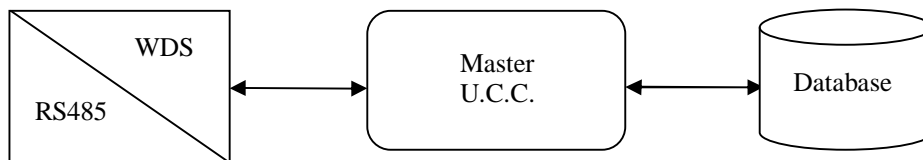
Figura 5: Schema blocchi impianto con sistema di trasmissione WDS e connessione al master
