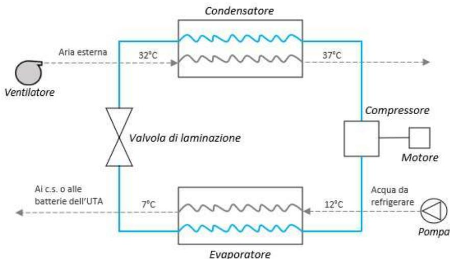
L'impianto generalmente garantisce sempre il funzionamento estivo da macchina frigorifera; talvolta funziona anche da pompa di calore in regime invernale.
