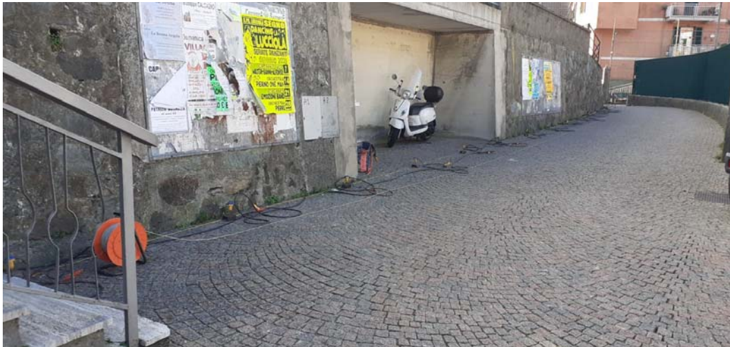
Indagine MASW ripresa da fine array (estremo geofono G14)
