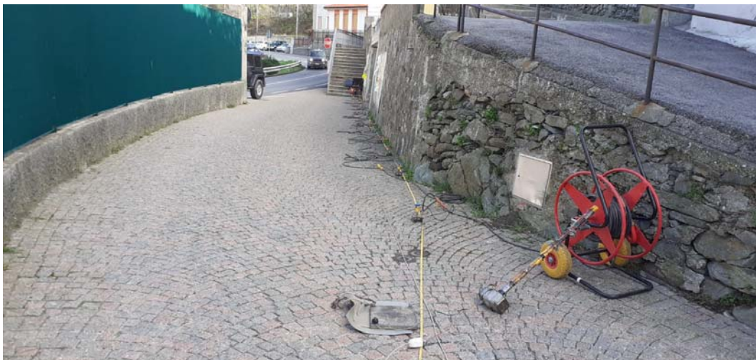
Indagine MASW: ultima energizzazione in offset (D = 2.0 m da geofono G1)
