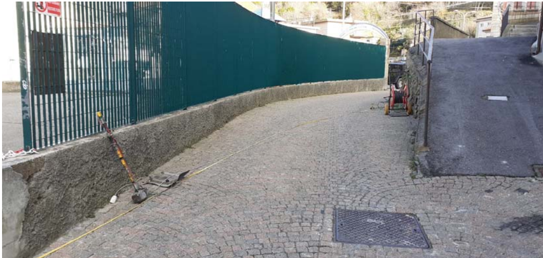
Indagine MASW: prima energizzazione in offset (D = 8.0 m da geofono G1)
