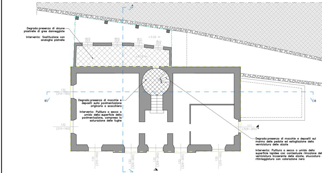
PIANTA SOTTOTETTO – sezione +9.44 m
