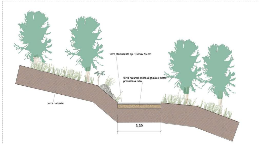
SEZIONE TRASVERSALE TIPO DELLO STATO DI PROGETTO
