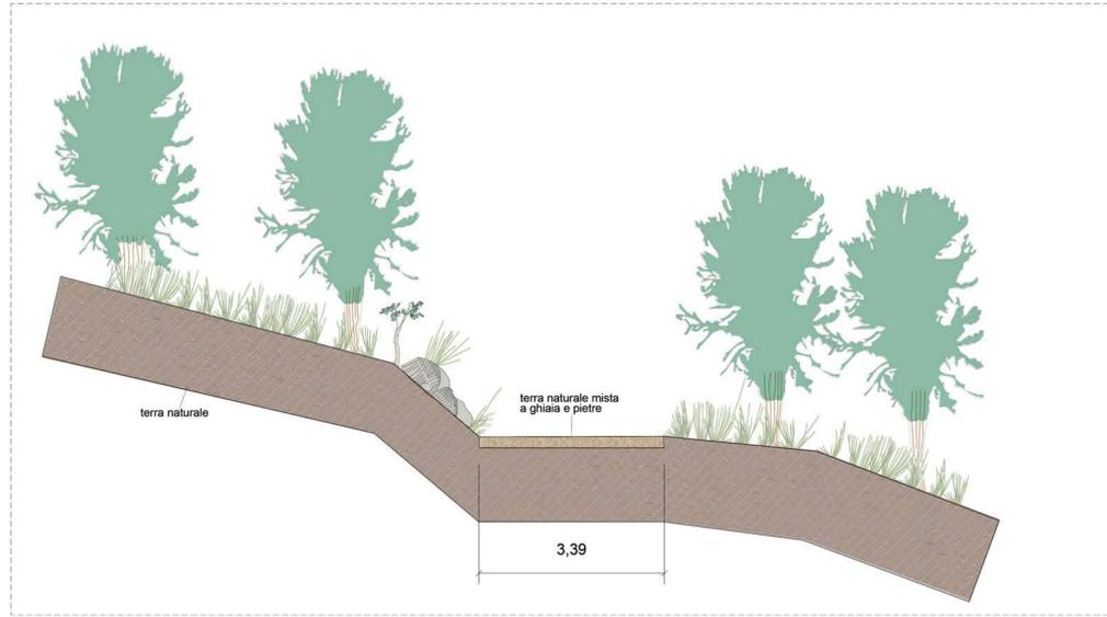
SEZIONE TRASVERSALE TIPO DELLO STATO DI FATTO
