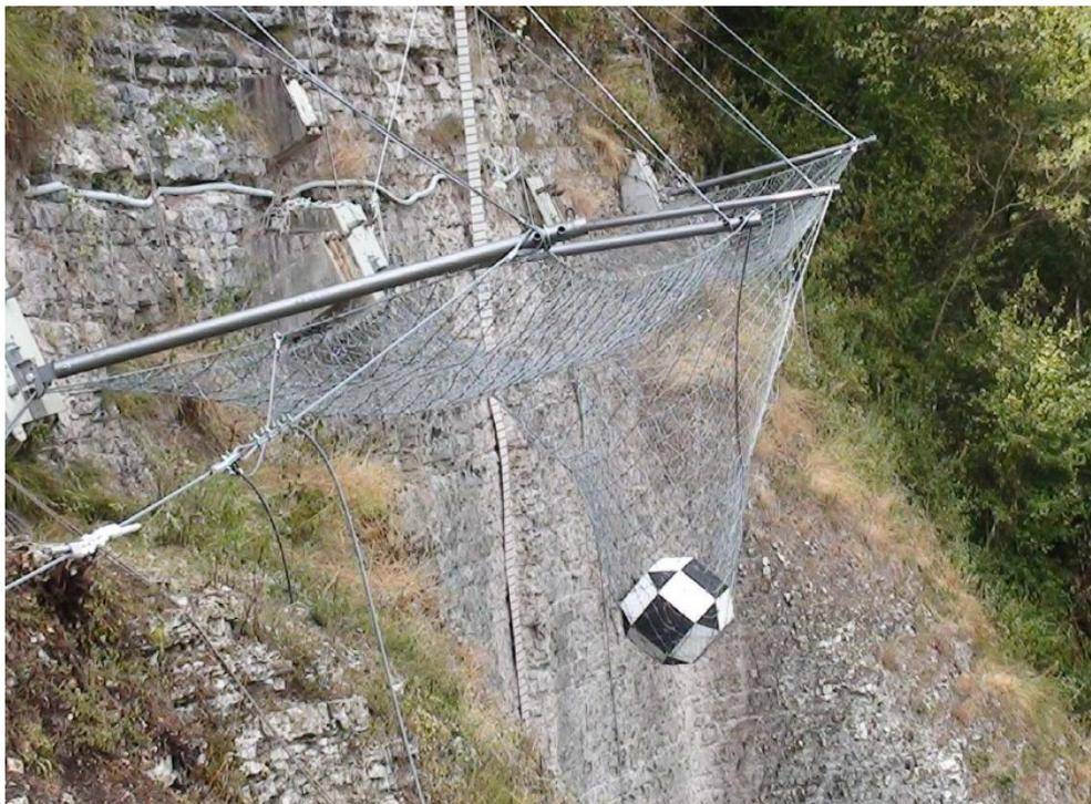
**Figura 4: barriera paramassi – test in vera grandezza**
