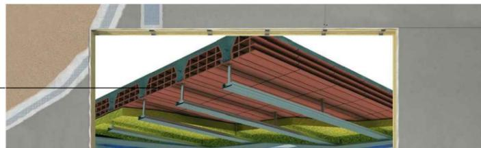
Dettaglio 1\_ Posa coibentazione soffitto con poliuretano espanso 120 mm + cartongesso
