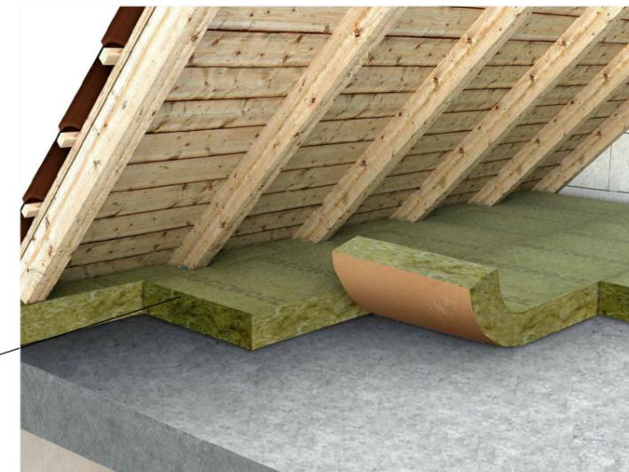
Dettaglio 3\_ Posa della lana di roccia 160 mm
