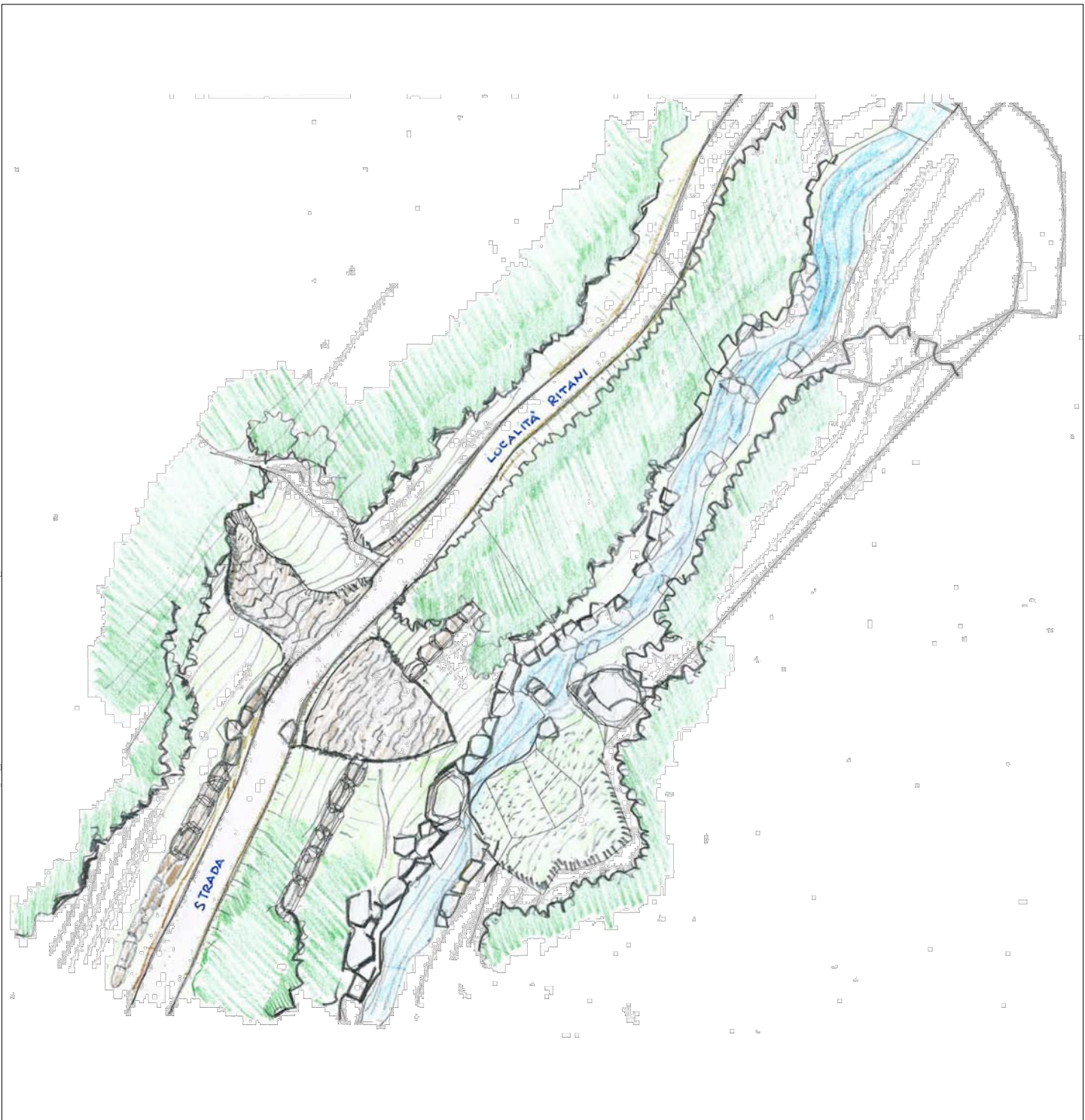
STATO ATTUALE Vista planimetrica dell'area interessata dal movimento franoso
