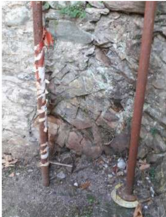
Fig.4 – Substrato in discrete condizioni conservative affiorante a valle di Via alla Fontana nel sito di intervento
