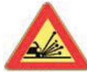
Figura II 390 Art. 31 MATERIALE INSTABILE SULLA STRADA
